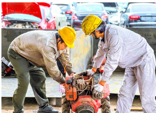
拆解报废农机发动机。
